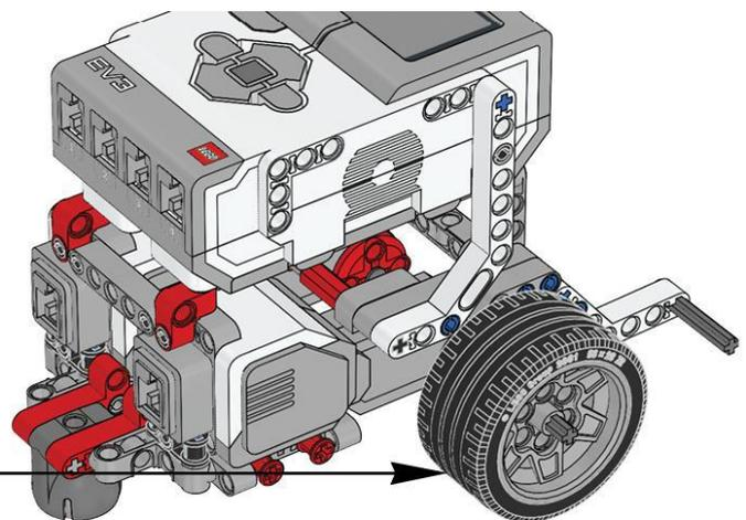
Na figura 38 há a indicação de que se deve montar o pneu na roda. No entanto, o pneu já deve estar na roda, assim, basta você encaixar no motor da base motriz.
